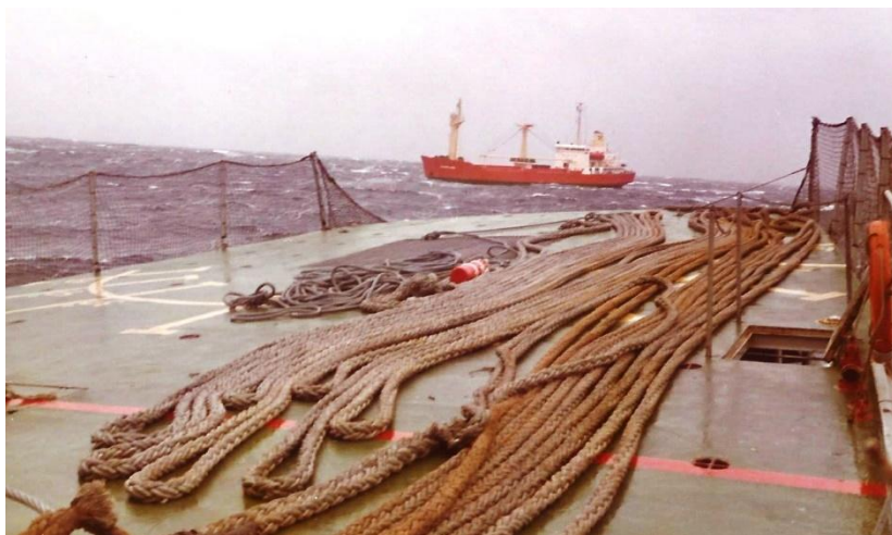
Al bugsergrajet ligger klar på helikopterdækket. Når Vædderen er tæt nok på, skydes en raket med en tynd line over til fragtskibet.
